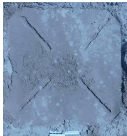
. 8. След от подпятника аутригера автокрана КАМАЗ 53229 КС45717К-1
