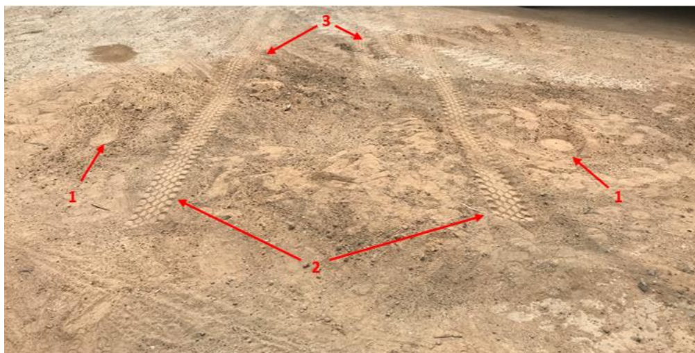
. 4. Следы мобильного грузоподъемного устройства на грунте: 1 – следы упоров (аутригеров) подъемной установки; 2 – следы колес передней оси автомобиля; 3 – следы сдвоенных колес задней оси автомобиля
