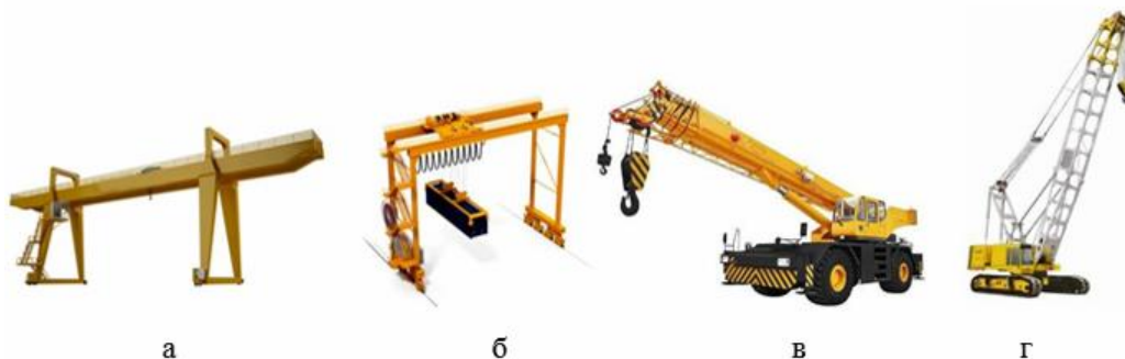
1. Грузоподъемные краны: а) краны мостового типа; б) краны-штабелеры; в) краны стрелового типа; г) самоходные краны
